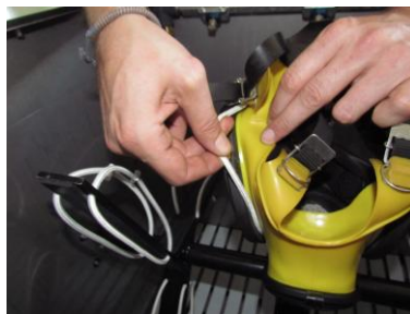
Spannband am Scheibenrahmen der Vollmasken einhängen
