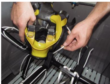
Spannband am Scheibenrahmen der Vollmasken einhängen
