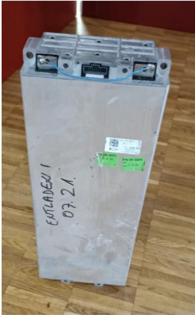
: Batteriemodul (linkes Bild) und ausreagiertes Batteriemodul nach einem thermal runaway (rechtes Bild)
