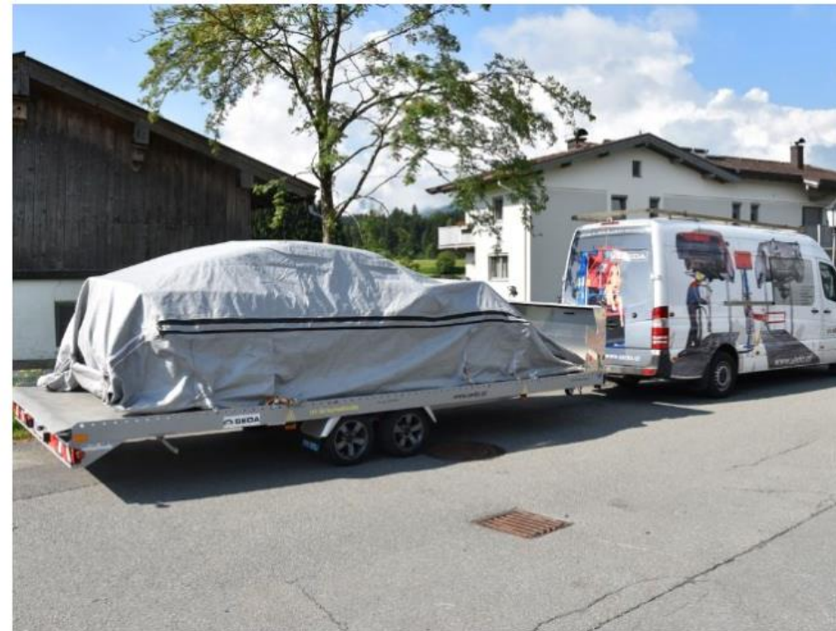
Abbildung 13: Beispiel für eine Elektro-Fahrzeug-Sicherheitshülle (Quelle: SEDA Umwelttechnik GmbH)
