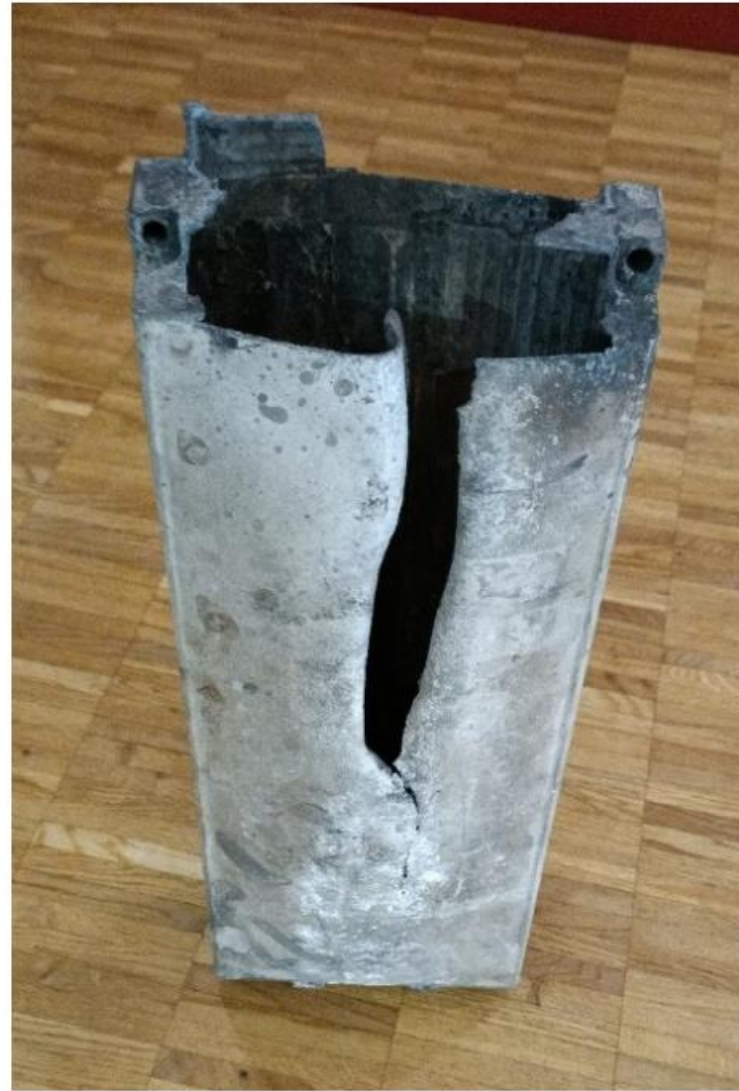
: Batteriemodul (linkes Bild) und ausreagiertes Batteriemodul nach einem thermal runaway (rechtes Bild)
